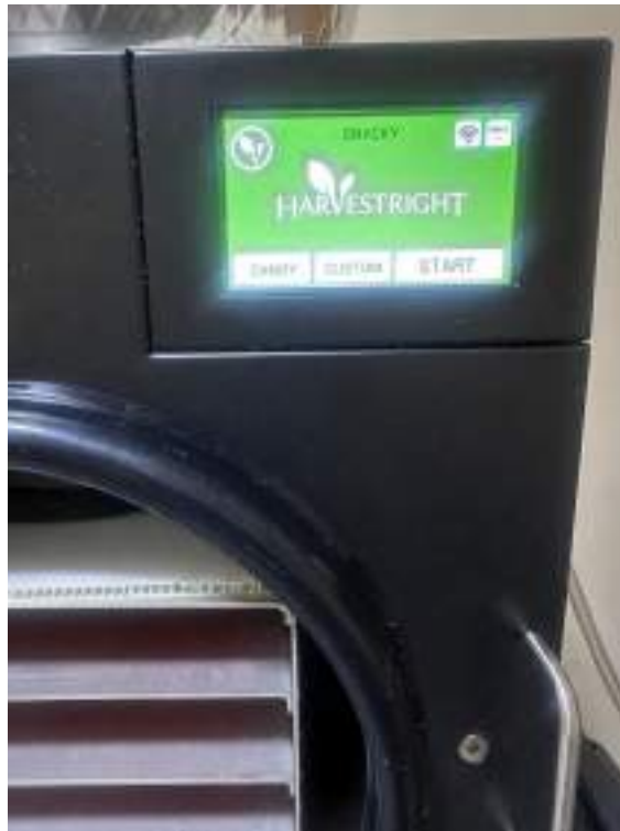
Imagen 27.- Liofilizador semi-industrial utilizado para la liofilización de la cáscara de mango
