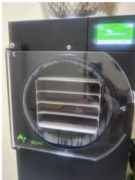
Imagen 28.- Liofilizador semi-industrial de cuatro bandejas con vista panorámica utilizado para la liofilización de la cáscara
