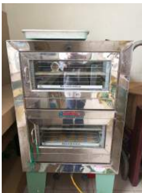
Imagen 20.- Horno semiindustrial de dos bandejas para el horneado de los totopos de maíz con cascara de mango liofilizado
