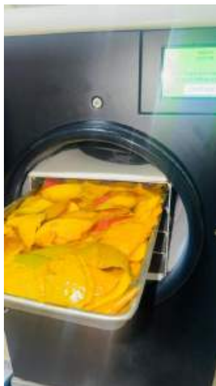
Imagen 18.- Cáscaras de mango liofilizadas una vez terminado el proceso
