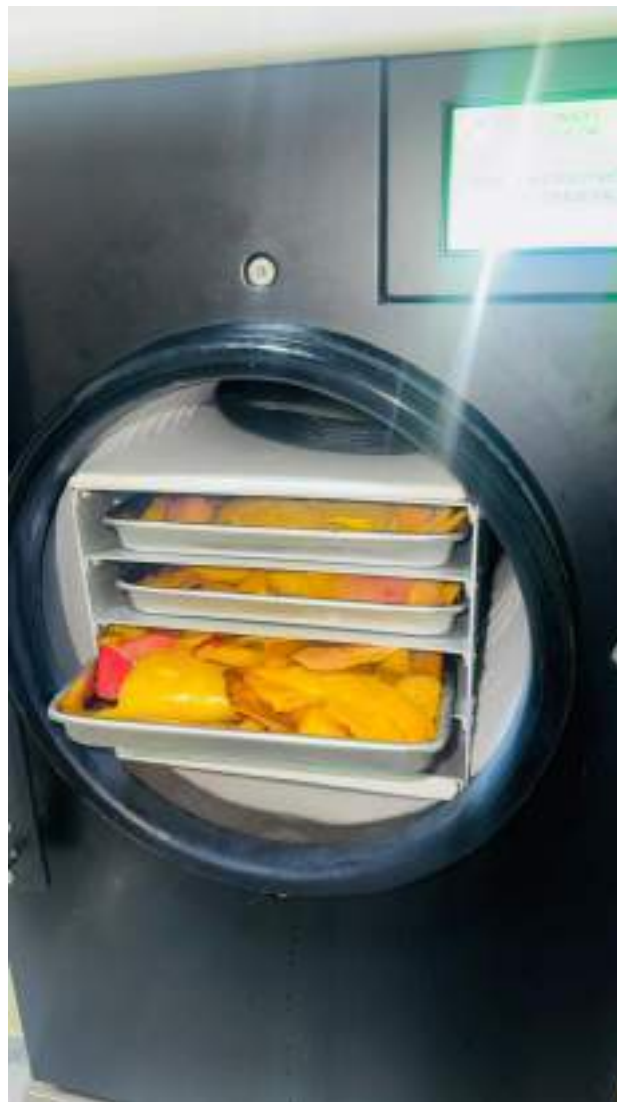
Imagen 16.- Bandejas de mango en el liofilizador antes de iniciar el proceso
